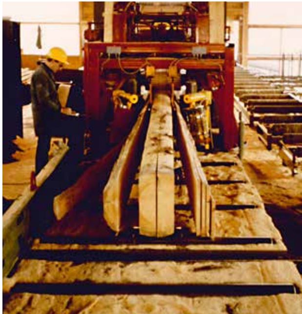
Kappung der Seitenwarenbretter im laufenden Sägeprozess am Sägegatter
