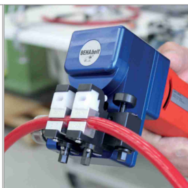
Schweiß-/Verbindungstechnik für PU und TPE
