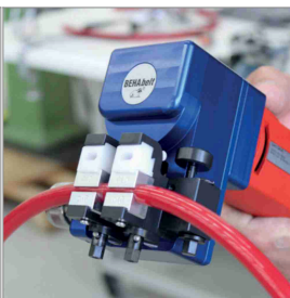
Schweiß-/Verbindungstechnik für PU und TPE
