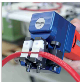
Schweiß-/Verbindungstechnik für PU und TPE
