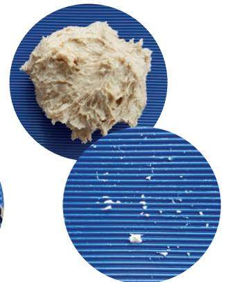
In einem Laborversuch mit einem Roggen-/Weizen-Mischteig bestätigte die Querrillen-Struktur ihr deutlich besseres Ablöseverhalten im Vergleich zu anderen häufig verwendeten Transportband-Oberflächen, wie glatt oder Diamantstruktur.
