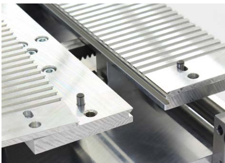
Arretierungsstifte sorgen für die richtige Positionierung der Adapterplatten auf dem Fügetisch.
