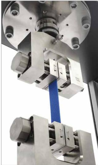
In base alla norma ISO 21181, il valore  $k1\%$  (N/mm) definisce il modulo di elasticità per i nastri trasportatori. Indica quanta forza in Newton per mm di larghezza di banda è necessaria per allungare un nastro dell'1%.
