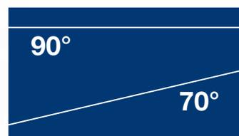
Saldatura diritta a 90° e giunzione obliqua a 70° (ad es. per nastri di pesatura)
