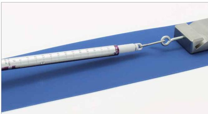
L'effetto del coefficiente di attrito statico più elevato a breve termine all'avvio (pari a circa 1,3-1,8 volte il coefficiente di attrito dinamico) viene solitamente preso in considerazione nella progettazione dell'impianto tramite il fattore di sicurezza scelto dal progettista.
