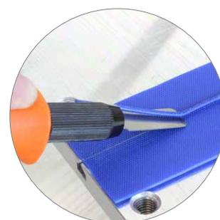
Facile rimozione del cordone di saldatura con l'attrezzo in dotazione
