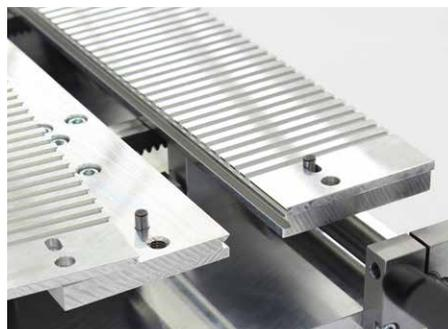
Los pasadores de bloqueo garantizan el posicionamiento correcto de las placas adaptadoras en la mesa de unión.
