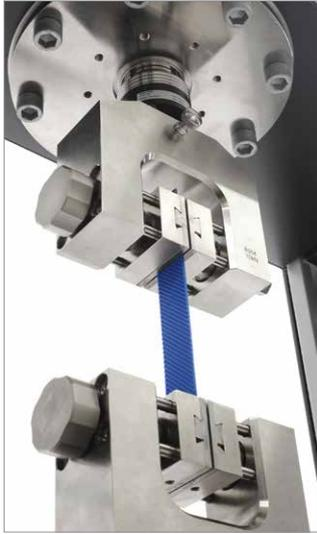
Basado en la norma ISO 21181, el valor  $k_1$  % (N/mm) define el módulo de elasticidad para las bandas transportadoras. Indica cuánta fuerza en newtons por mm de ancho de banda se necesita para estirar una cinta un 1 %. En otras palabras: ¿cuánto (en %) debe tensarse una correa para alcanzar una fuerza determinada en el tambor de accionamiento? En la práctica se utilizan dos valores  $k_1$ % diferentes ( $k_1$ % estático, relajado).
