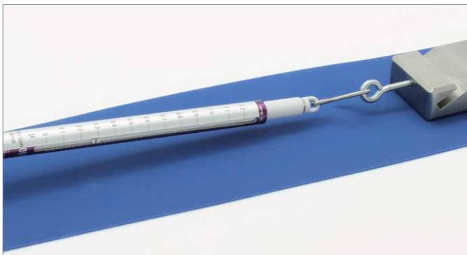
El efecto del mayor coeficiente de fricción estática de corta duración durante el arranque (aproximadamente entre 1,3 y 1,8 veces el coeficiente de fricción dinámica) se tiene en cuenta normalmente en el diseño de la instalación mediante el factor de seguridad seleccionado por el diseñador.
