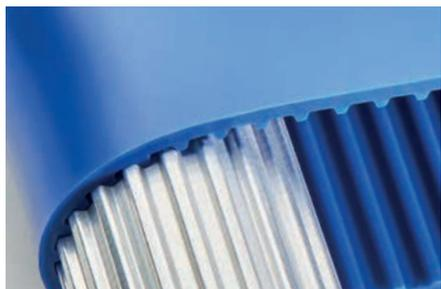
I nastri trasportatori AT5 form-fit consentono un trasporto senza slittamenti, anche con i diametri delle pulegge più piccoli, di soli 18 mm. Ciò significa che anche le sezioni di trasporto con le condizioni di trasferimento più ridotte possono essere realizzate con una soluzione a nastro antiscivolo. Grazie all'attenta selezione delle materie prime destinate al contatto diretto con gli alimenti, le soluzioni a nastro offrono un'ottima resistenza ai microbi, all'idrolisi e agli agenti chimici.
