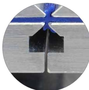
Barre di serraggio smussate per una sagomatura ottimale del cordone di saldatura
