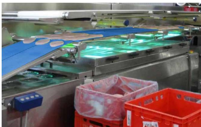
Per favorire la pulizia regolare, sempre più sistemi di trasporto sono dotati di lampade UV-C. Ciò serve a migliorare il controllo del numero di germi sulle superfici a contatto con gli alimenti anche durante il processo di produzione. Questo tipo di irradiazione porta alla fragilità e allo scolorimento della superficie del nastro in assenza di protezione.
