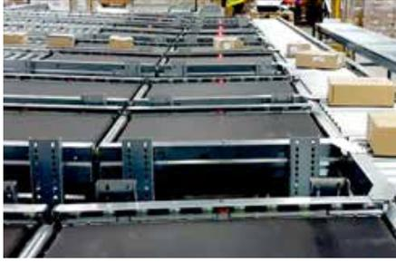
Elastiche Bänder in der Intralogistik reduzieren die Kosten des Anlagendesigns, da weitgehend auf Spannstationen verzichtet werden kann. Je nach Fördergut oder -art (z.B. Staubetrieb, Steigförderer) werden verschiedenste Bandtypen benötigt. Durch das 2K-Verfahren von BEHAbelt können somit auch 2 unterschiedliche Durezzagrade in einem Band zusammengeführt werden, um beispielsweise für eine Steigförderung die Lato trasporto mit mehr Grip auszustatten.
