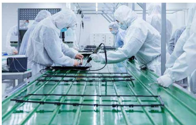
Per le sezioni di processo particolarmente sensibili con unità di misura e controllo elettroniche, come le pesatrici a controllo (processi di pesatura online) o le sezioni di trasporto con componenti elettronici, sono necessari nastri con proprietà dissipative antistatiche per evitare malfunzionamenti o errori di misura.
