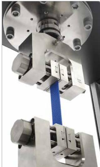
In base alla norma ISO 21181, il valore  $k1\%$  (N/mm) definisce il modulo di elasticità per i nastri trasportatori. Indica quanta forza, espressa in Newton per mm di larghezza del nastro, è necessaria per allungare un nastro dell'1%. In altre parole, di quanto (in %) deve essere teso un nastro per ottenere una certa forza sul tamburo di trasmissione. In pratica, si utilizzano due diversi valori di  $k1\%$  ( $k1\%$  statico, si rilassa).
