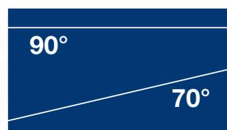
Soldadura recta con 90° y junta conexión con 70° (por ejemplo, para bandas de pesaje)
