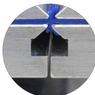
Barras de sujeción biseladas para una conformación óptima del cordón de soldadura
