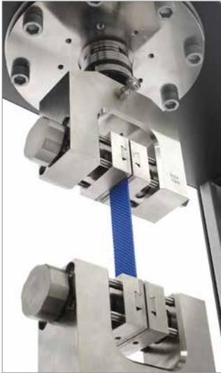
Basado en la norma ISO 21181, el valor  $k1\%$  (N/mm) define el módulo de elasticidad de las bandas transportadoras. Indica cuánta fuerza en Newton por mm Ancho de banda es necesaria para estirar una banda un 1%. En otras palabras: cuánto (en %) debe tensarse una banda para alcanzar una determinada fuerza sobre el tambor de accionamiento. En la práctica, se utilizan dos valores  $k1\%$  diferentes ( $k1\%$  estático, relajado).
