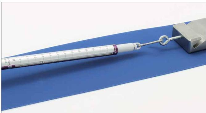
L'effet du coefficient de frottement statique plus élevé à court terme au démarrage (environ 1,3 à 1,8 fois le coefficient de frottement dynamique) est généralement pris en compte dans la conception de l'installation par le constructeur via le coefficient de sécurité choisi.
