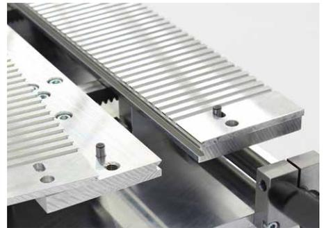
Des goupilles de blocage assurent le positionnement correct des plaques d'adaptation sur la table d'assemblage.
