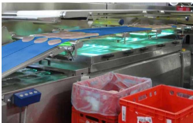
En complément du nettoyage régulier, de plus en plus de convoyeurs sont équipés de lampes UV-C. Cela permet de mieux contrôler le nombre de germes sur les surfaces en contact avec les aliments, même pendant le processus de production. En l'absence de protection, ce type d'irradiation entraîne une fragilisation et une décoloration de la surface de la bande.
