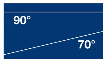
Soudure droite à 90° et raccord oblique à 70° (par exemple pour les bandes de pesage)
