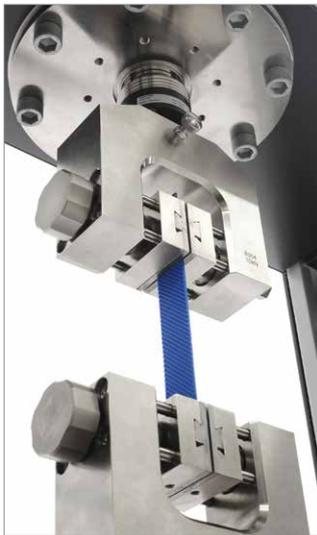
Conformément à la norme ISO 21181, la valeur  $k_1$  % (N/mm) définit le module d'élasticité des bandes transporteuses. Il indique la force en newtons par mm de largeur de bande nécessaire pour étirer un ruban de 1 %.
