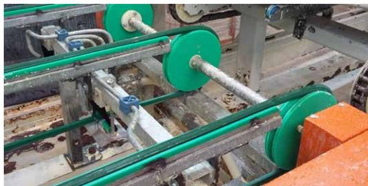
Las correas trapezoidales con cresta BEHAbelt están fabricadas de PU o TPE soldable. Son especialmente adecuadas para secciones del transportador exigentes en la industria de materiales de construcción y industria cerámica. Esta gama de productos contiene materiales extremadamente resistentes al desgaste en diferentes durezas Shore.
