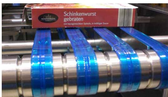
Los perfiles en T son ideales para transportar diversos productos ligeros y alimenticios, por lo que, por regla general, varias correas con perfiles en T funcionan una al lado de la otra. La cuña de guía integrada en el lado de desplazamiento evita que los perfiles sufran un error de seguimiento lateral y garantiza así un desplazamiento recto y preciso. La gama de productos de BEHAbelt incluye perfiles en T con diferentes geometrías, durezas Shore de PU y combinaciones de colores.
