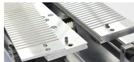
Des goupilles de blocage garantissent le positionnement correct des plaques d'adaptation sur la table d'assemblage.
