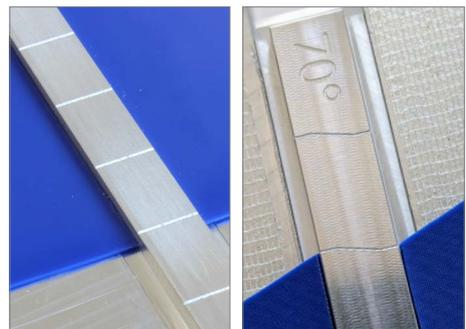
Aluleiste für präzises und fluchtendes Einlegen der Bandenden.
