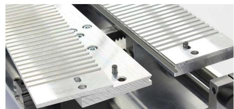
Arretierungsstifte sorgen für die richtige Positionierung der Adapterplatten auf dem Fügetisch.
