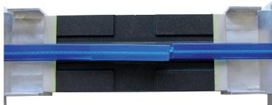
Die beiden Enden mittig einlegen und seitlich mit den Klemmschrauben befestigen. Die beschnittenen Riemendenenden liegen dabei bündig überlappend übereinander. Die eingefrästen Nuten des Formschuhs zeigen die Mitte des Ober- und Unterteils.
