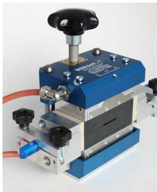
Introduzca el molde con el perfil en la prensa térmica situado en posición centrada en sentido longitudinal:
