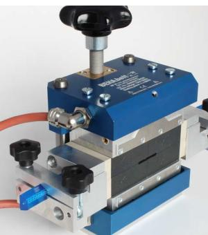
Installer l'empreinte avec le profil dans la presse à chaud : L'installer au centre dans le sens de la longueur. Les rainures dans l'empreinte et celles dans les parties supérieure et inférieure du boîtier doivent se chevaucher. Installer l'empreinte de manière centrée par rapport aux plaques chauffantes dans la longueur.
