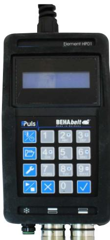
Conecte el enchufe de red del controlador PPuls a la red y conecte el controlador PPuls. Realice la selección de los parámetros de soldadura mediante introducción directa o selección de las fórmulas guardadas.
