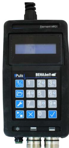
Brancher la fiche secteur du contrôleur PPuls dans la prise murale et allumer le contrôleur PPuls. Sélection des paramètres de soudure par saisie directe ou sélection de recettes mémorisées.
