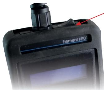
Actionner l'interrupteur Arrêt sur le contrôleur PPuls ou débrancher la fiche de la prise secteur.
