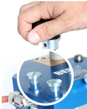
Gire el tornillo de mando estrellado hacia la derecha para desplazar hacia abajo la placa calentadora superior hasta que entre en contacto con el molde. A continuación, siga girando el tornillo de mando estrellado hasta que las cabezas de los tornillos se levanten 3-4 mm de la placa superior de la carcasa.
