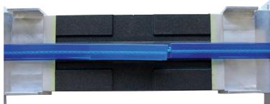
Inserte los dos extremos en el centro y fíjelos lateralmente con los tornillos de apriete. Los extremos de la correa están colocados uno sobre otro a ras y solapados. Las ranuras fresadas del molde indican el centro de la parte superior y de la parte inferior.
