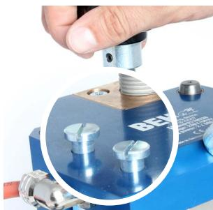
Durch Rechtsdrehen der Sterngriffschraube die obere Heizplatte nach unten stellen, bis sie Kontakt mit dem Formschuh hat. Anschließend Sterngriffschraube weiter drehen, bis sich die Schraubenköpfe 3-4mm von der oberen Gehäuseplatte abheben.
