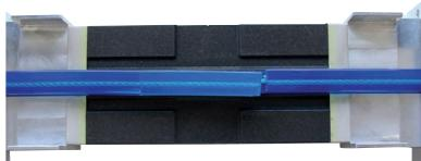
Installer les deux extrémités au centre et les fixer sur le côté avec les vis de serrage. Les extrémités coupées des courroies doivent se chevaucher et être alignées l'une sur l'autre. Les rainures fraîssées de l'empreinte sont orientées vers le centre des parties supérieure et inférieure.
