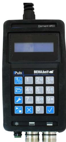
Den Netzstecker des PPuls Controllers am Netz anstecken und den PPuls Controller einschalten. Wahl der Schweißparameter durch Direkteingabe oder Auswahl gespeicherter Rezepte.
