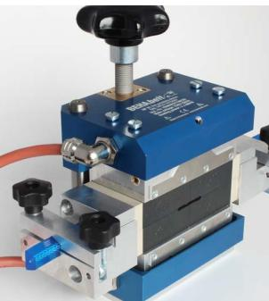
Introduzca el molde con el perfil en la prensa térmica: Introdúzcalo centrado longitudinalmente. Las ranuras en el molde y las ranuras en la parte superior y en la parte inferior de la carcasa deben cubrirse. Introduzca el molde longitudinalmente centrado con respecto a las placas calentadoras.
