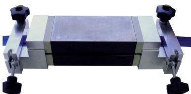
Pour fermer la partie supérieure, placer la partie inférieure exactement entre les passerelles de guidage. Dans le cas de la soudure par chevauchement, les parties supérieure et inférieure ne se touchent pas au début étant donné que le matériel doit d'abord être comprimé pendant la soudure ou pendant le temps de maintien.
