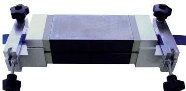
Zum Schließen das Oberteil passgenau auf das Unterteil zwischen die Führungsstege einlegen. Beim Überlappschweißen berühren sich Ober- und Unter teil zunächst nicht, da das Material beim Schweißvorgang bzw. während der Haltezeit erst noch verdrängt werden muss.
