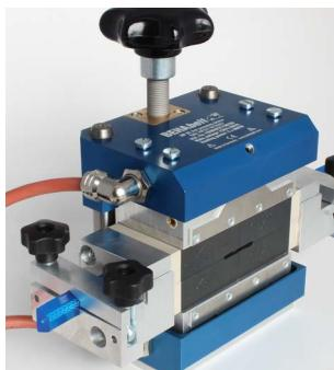
Den Formschuh mit Profil in die Heißpresse einsetzen: Längs mittig einsetzen. Die Nuten im Formschuh und die Nuten im Gehäuseoberteil und -unterteil müssen sich überdecken. In der Länge den Formschuh vermittelt zu den Heizplatten einlegen.
