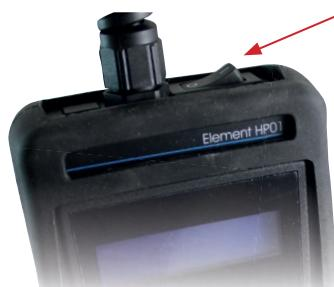
Den Aus-Schalter am PPuls Controller betätigen oder Netzstecker vom Netz trennen.
