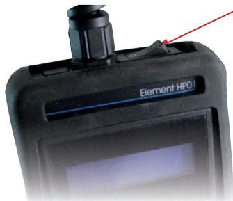
Accione el interruptor de desconexión en el controlador PPuls o retire el enchufe de red de la red.
