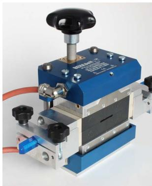
Installer l'empreinte avec le profil dans la presse à chaud en la centrant dans le sens de la longueur :
