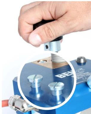
Déplacer la plaque chauffante supérieure vers le bas en tournant la vis à molette vers la droite jusqu'à ce qu'elle soit en contact avec l'empreinte. Puis continuer à tourner la vis à molette jusqu'à soulèvement des têtes de vis de 3 à 4 mm de la plaque supérieure du boîtier.
