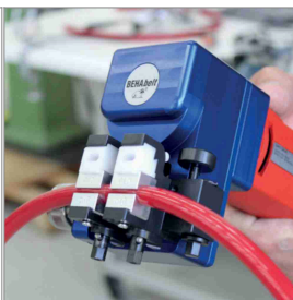
Technologia spawania/łączenia PU i TPE
