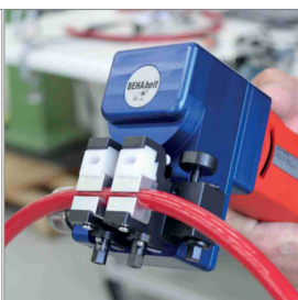
Tecnologia di saldatura/giunzione per PU e TPE
