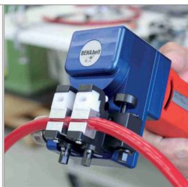
Tecnología de soldadura/unión para PU y TPE
