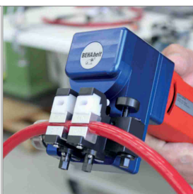
Technika svařování/spojování pro PU a TPE
