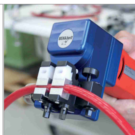
Technika svařování/spojování pro PU a TPE
