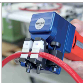
Technika svařování/spojování pro PU a TPE
